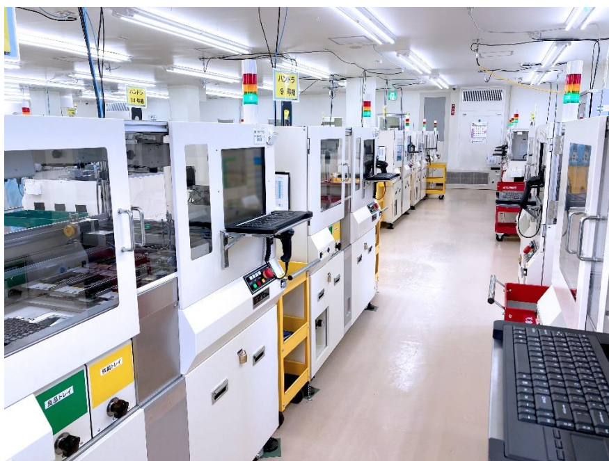
大型自動プログラミングシステム（ハンドラ）を大規模増設したMA Tクリーンルーム
